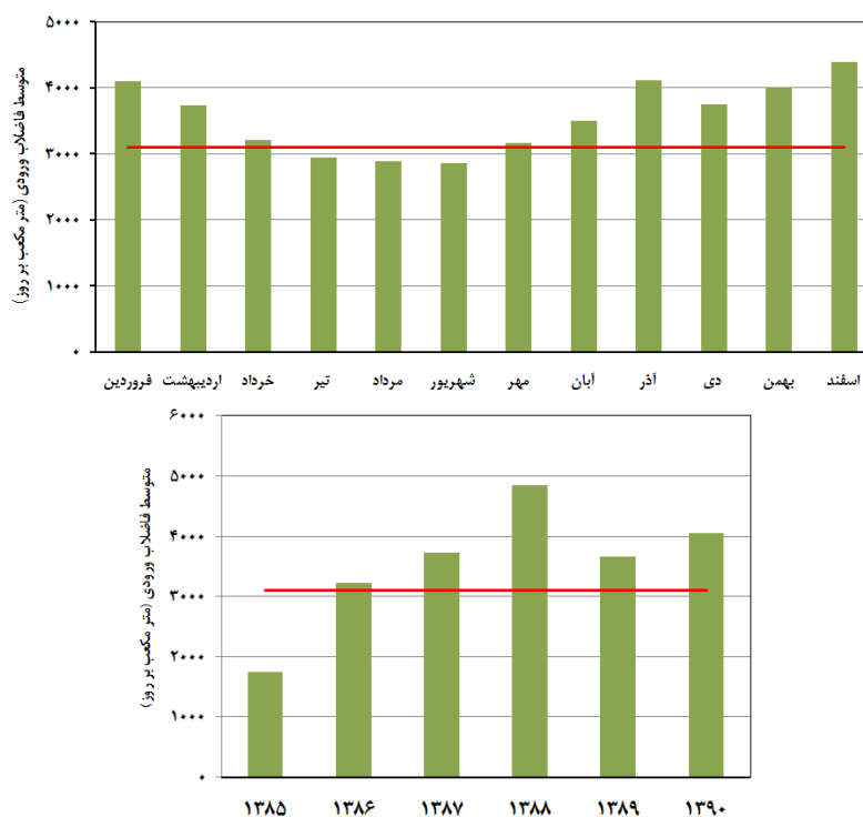
شکل ۲- نوسانات فاضلاب ورودی به تصفیه‌خانه در ماه‌ها (بالا) و سال‌های (پایین) مختلف (مترمکعب بر روز)
