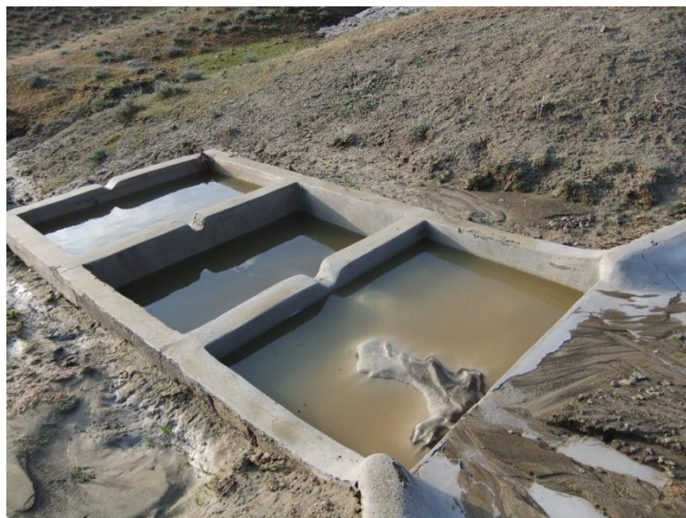
شکل ۶- نمونه‌ای از مخزن سه قسمتی اندازه‌گیری رسوب در یکی از زیرحوضه‌های ایستگاه تحقیقات فرسایش خاک سنگانه
