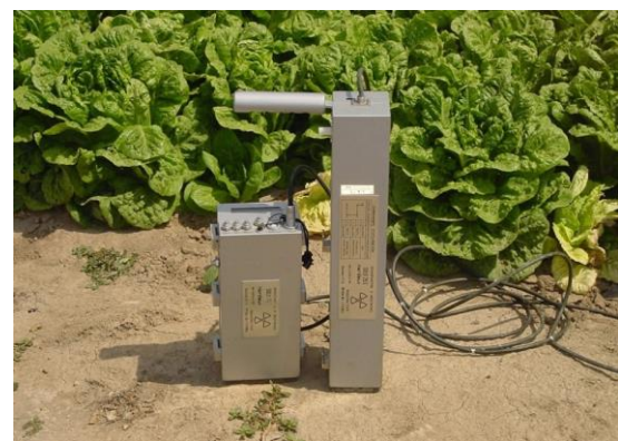
شکل ۲- تصویر یک کاوشگر نوترون‌متری مستقر در مزرعه زعفرانیه پژوهشکده کشاورزی هسته‌ای واقع در کرج (تصویر سمت راست)؛ شماتیک اجزای کاوشگر و نحوه استقرار در سطح خاک (تصویر سمت چپ)
