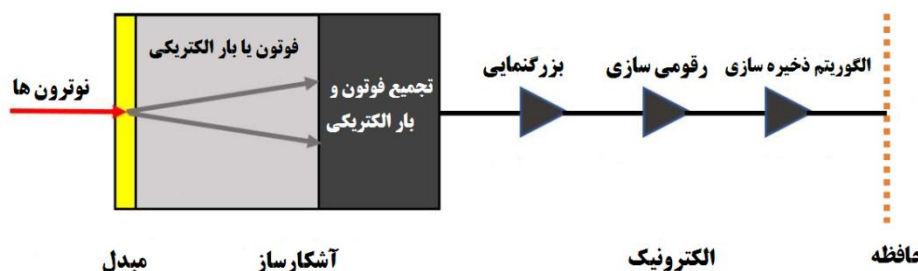
شکل ۱- نمای کلی اجزای آشکارساز کاشگر نوترونی (برگرفته از آژانس بین‌المللی انرژی اتمی، ۲۰۲۰)
